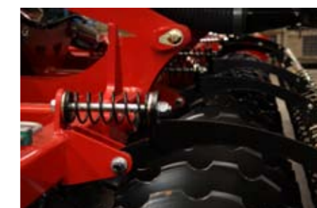
Peigne suiveur tenu par ressort en aval des outils
