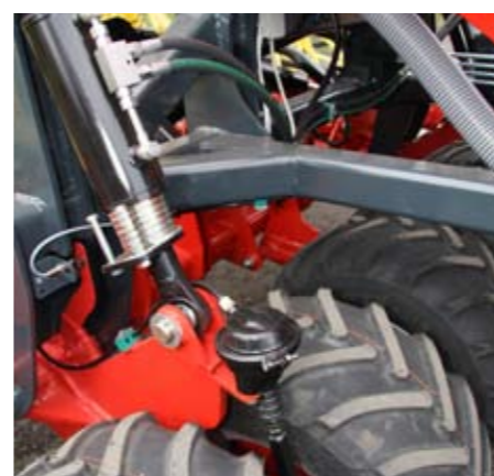
Réglage de la profondeur du tasseur à pneus par des rondelles d'écartement sur le vérin hydraulique
