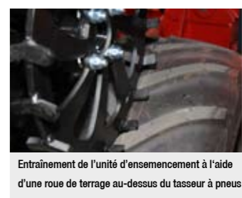
Entraînement de l'unité d'ensemencement à l'aide d'une roue de tassage au-dessus du tasseur à pneus
