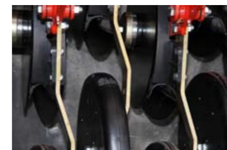
Des racloirs en caoutchouc aux bords en carbure assurent le déroulement impeccable des semailles
