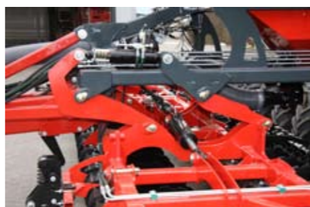
Réglage de la profondeur de travail par des rondelles d'écartement sur le vérin hydraulique, levage et descente parallèle des outils de travail, sans décalage de l'angle d'attaque des outils
