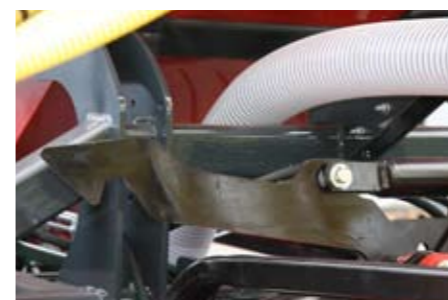
Verrouillage automatique de la position de transport du rail d'ensemencement par vérin hydraulique
