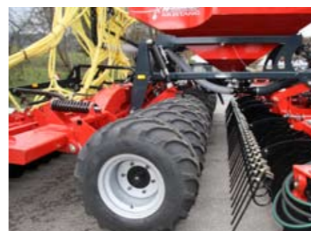
Tenus également par ressort sur les bras latéraux, les pneus tasseurs assurent un bon tassement du sol
