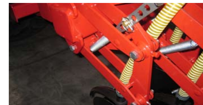
Socs à double disque en parallélogramme avec rouleaux tasseurs et peigne suiveur
