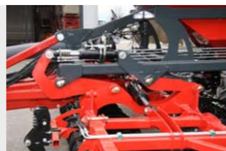
Réglage de la profondeur de travail par des rondelles d'écartement sur le vérin hydraulique, levage et descente parallèle des outils de travail, sans décalage de l'angle d'attaque des outils
