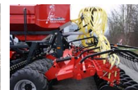
Vérin hydraulique avec rondelles d'écartement pour régler l'angle d'inclinaison et la profondeur de travail
