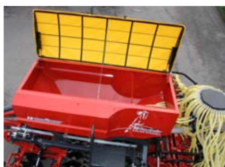
Large ouverture de remplissage du réservoir, le couvercle du réservoir s'ouvre facilement sous l'effet d'un vérin à gaz comprimé
